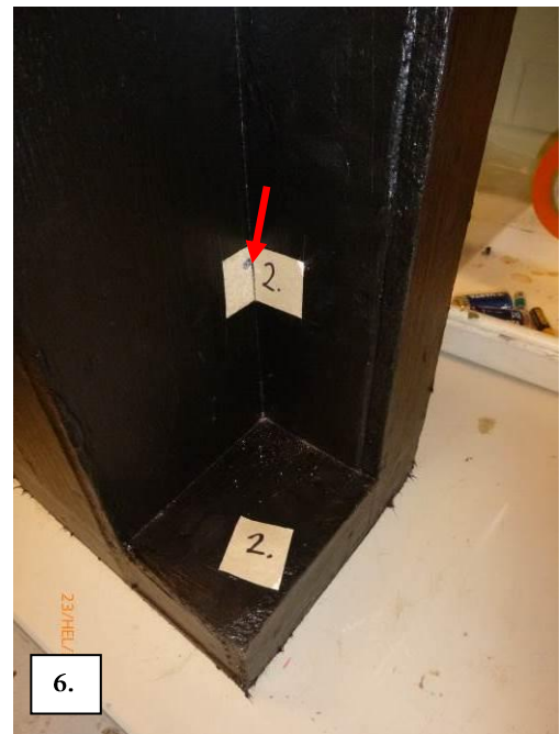
Kuvat 5 ja 6. Materiaalinäytteiden ottokohdat testikappaleessa.
