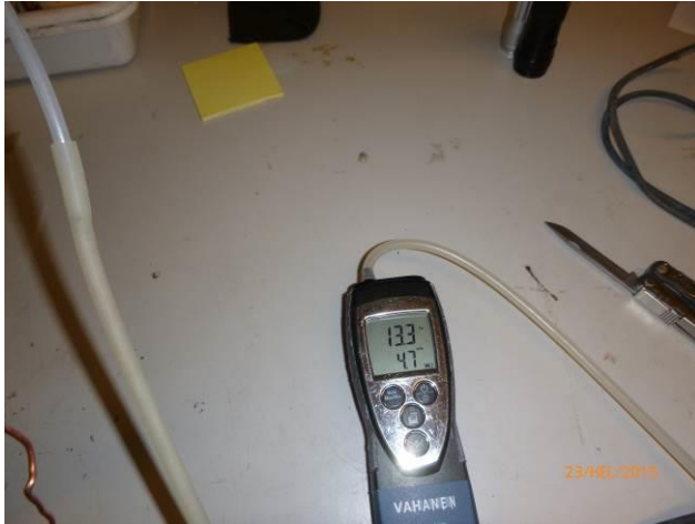
Kuva 3. Testilaatikko ylipaineistettiin mittauksen ajaksi n. 11-13 Pa ylipaineeseen.
