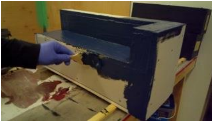
Kuva 1. Testikappaleen tiivistys käynnissä Blowerproof Liquid Brush massalla.
